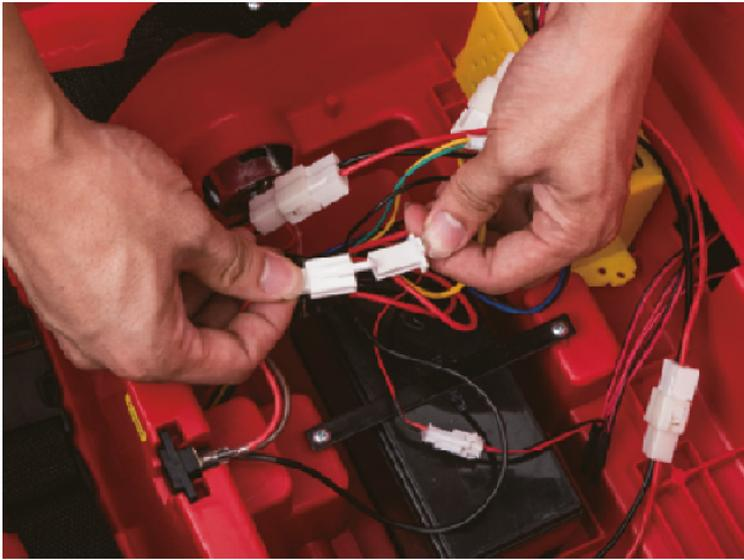
Conectar la alimentación como se muestra en la foto, verificando que queden bien fijadas las conexiones.
