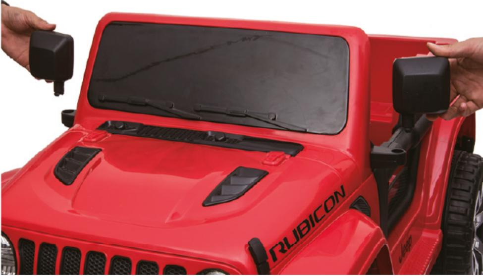
Coloque los espejos retrovisores presionando hacia abajo hasta que quede fijo.
