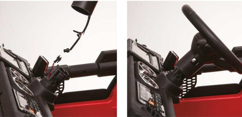
Conecte primero el cable de alimentación y, a continuación, monte el volante presionándolo directamente hacia abajo.
